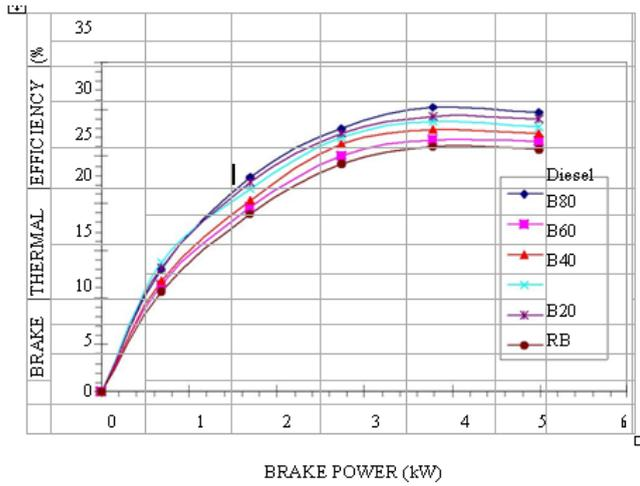
FIGURE 1. VARIATION OF BRAKE THERMAL EFFICIENCY vs. Brake power
