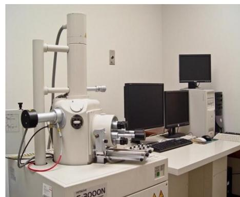
**Fig. 5.1: SEM apparatus**
